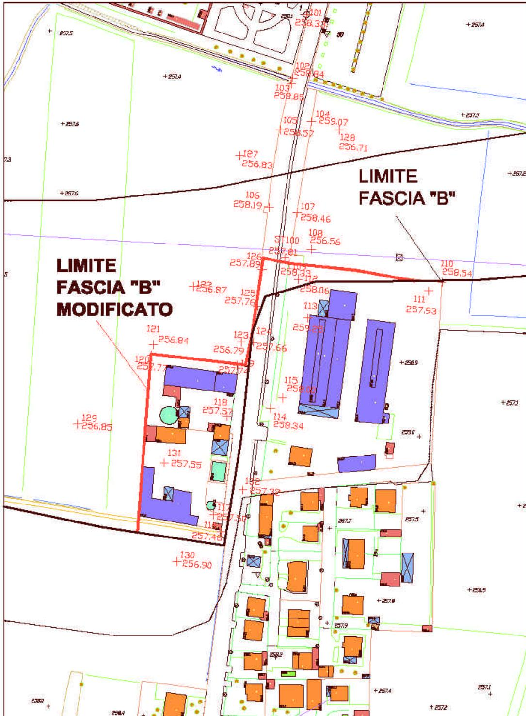
Figura 3 – Planimetria della proposta di modifica del limite della Fascia B del torrente Lemina (area a nord del concentrico), sulla base dei criteri di cui all’art. 27 comma 3 delle Nda del PAI – scala 1:2.000 ; in rosso le quote del rilievo topografico.
